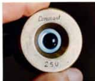
Eine der "Oesen" zum Durchziehen des Walzdrahts
