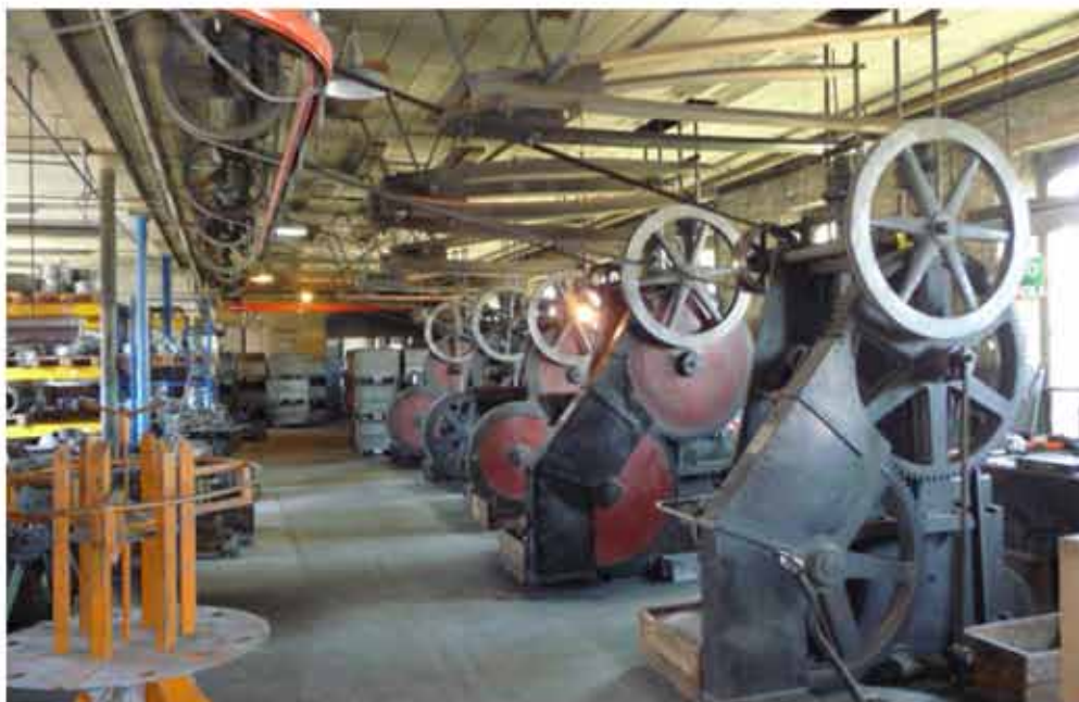
Die 5 übrig gebliebenen Stiftschlagmaschinen mit ihrem an der Decke montierten Antrieb und den Holzfedern
